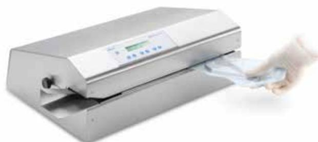
Das Durchlauf-Siegelgerät **MELAseal® Pro** vermeidet Fehler durch intuitive Bedienung mit Softkeys und LCD-Display. Hohe Durchlaufgeschwindigkeit von 8 m/min. Zusätzliche Sicherheit durch Siegelnahtbreite von 14 mm. Serielle Schnittstelle für Protokollausgabe per Drucker, CF-Card-Printer oder PC.
