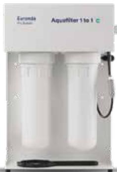
**Aquafilter 1to1** ist ein Wasserfilter zur Herstellung von demineralisiertem Wasser in Übereinstimmung mit der EN 13060 (Leitfähigkeit  $<15 \mu\text{S}/\text{cm}$ ). Eine mehrfarbige LED signalisiert die Wasserqualität und den rechtzeitigen Wechsel der Mischbettharz-Patronen ohne Ausfallzeiten.
